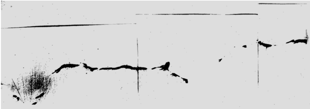
Рис. 4. Зовнішній вигляд дефекту на мікрошліфі у нетравленому стані
